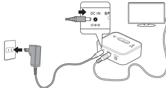
送信機とテレビの接続が完了したら、送信機に付属のACアダプターを接続してください。ACアダプターは送信機のDC IN端子に接続したあとで、コンセントに接続してください。ACアダプターを抜くときは先にコンセントから抜いてください。
