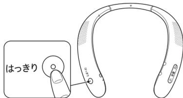
テレビで流れているセリフを聞き取りやすく補正します。はっきり音機能は、出荷時はオンになっています。はっきり音機能がオンになっているときは、はっきりランプが橙色で点滅します。スピーカー（受信機）のはっきりボタンを押すと機能をオフにできます。
